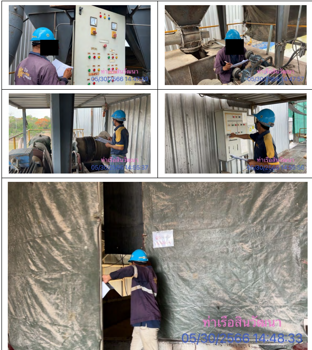
รูปที่ 2.2-12 การตรวจสอบสภาพเครื่องดักจับฝุ่น (Bag Filter) ก่อนลงสินค้าทุกครั้ง เพื่อให้ใช้งานได้ดีอยู่เสมอ
