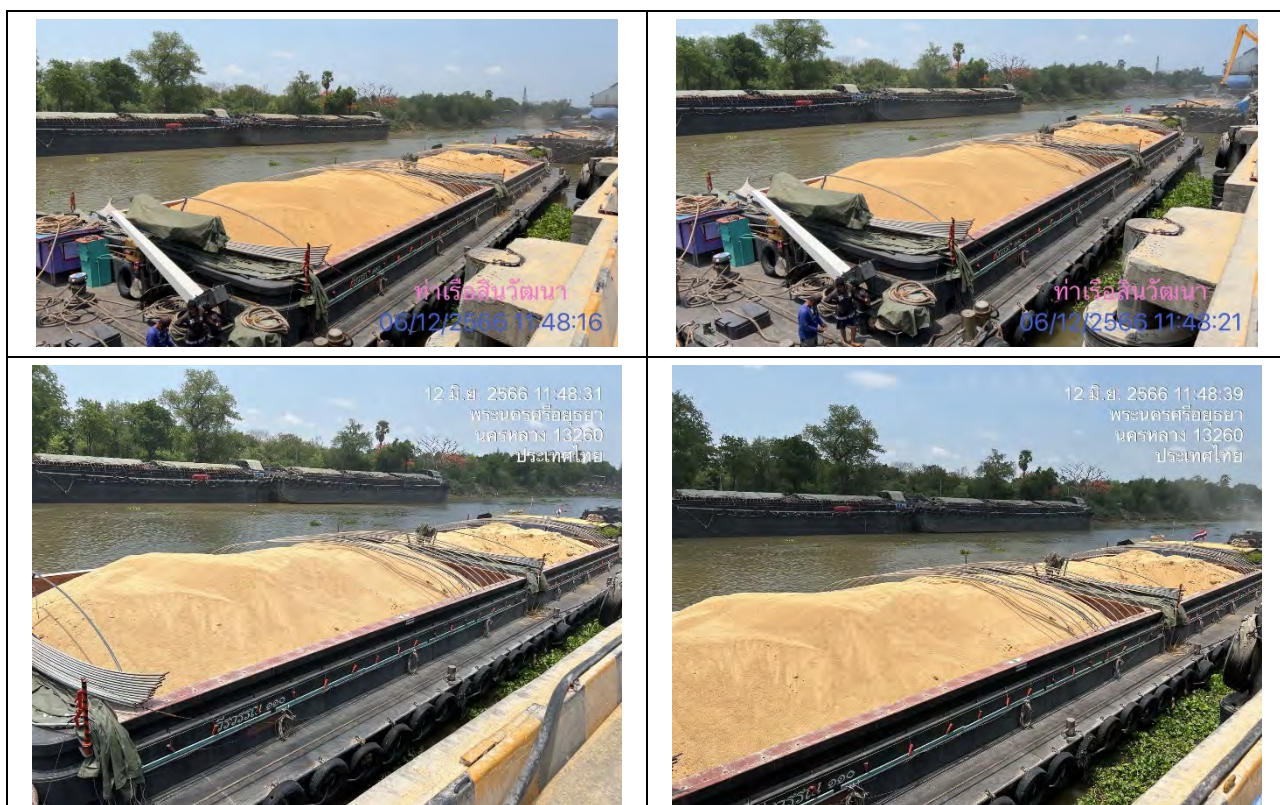
รูปที่ 2.2-14 การบรรทุกสินค้าไม่เกินร้อยละ 70 ของระวางเรือ และกองสินค้าต้องไม่เกินโค้งเรือ
