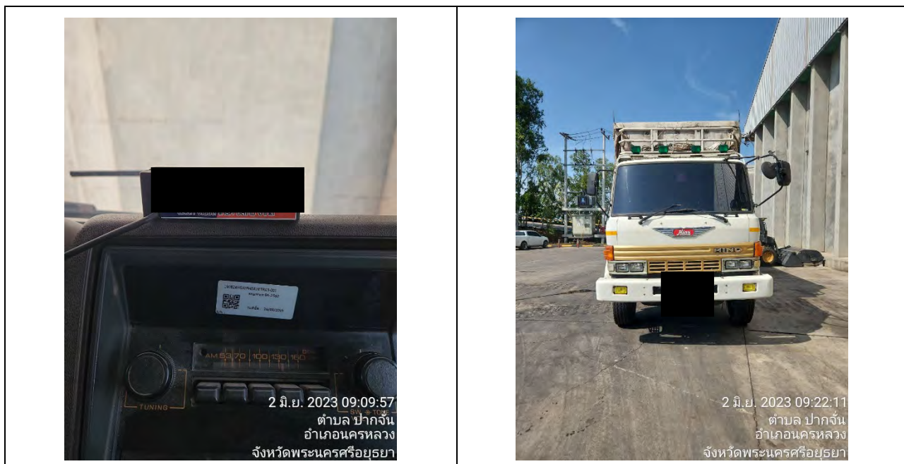
รูปที่ 2.2-34 การติดตั้งระบบ GPS ให้กับรถบรรทุกสินค้าของโครงการเพื่อติดตามตรวจสอบเส้นทางและการ ใช้ความเร็วของรถบรรทุกสินค้าของโครงการ
